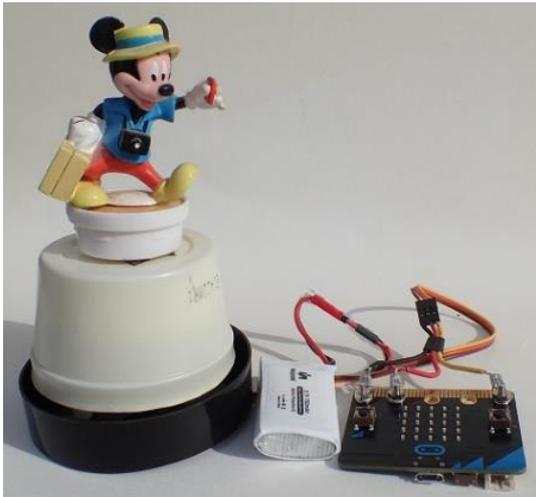
ミッキーマウスを載せたカップにサーボモータを入れてあります。小さいデスク状の強力マグネットの対を通して動力を伝えています。-
